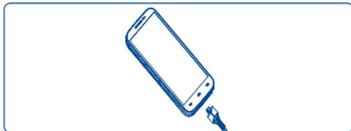
Conecte el cargador de la batería al teléfono y a una toma de corriente.
