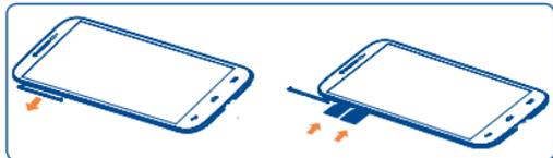
Para introducirla, retire el protector de la tarjeta micro-SIM, inserte la tarjeta micro-SIM en la ranura con el chip apuntando hacia abajo y luego cierre la ranura.
